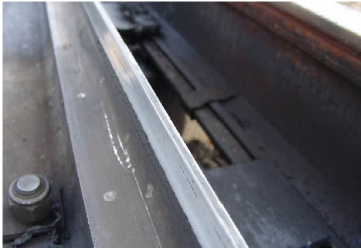
Obrázek 33 - boční ojetí hrotu jazyka jízdním obrysem kola
